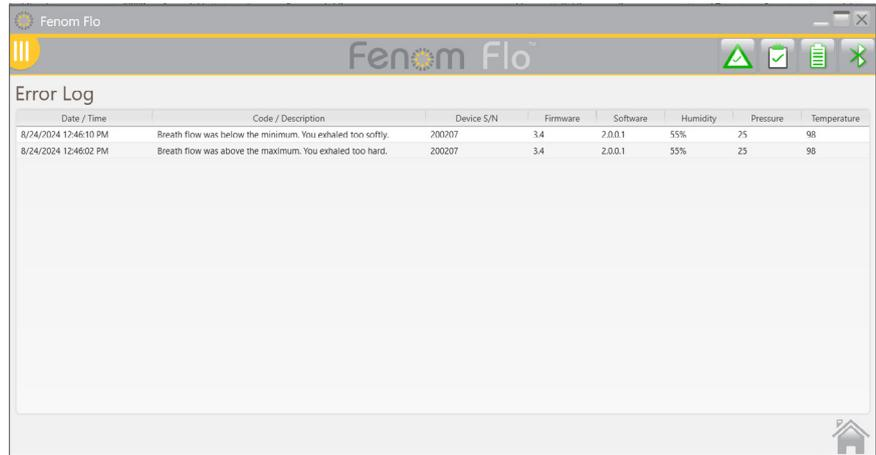
3. Alle aufgetretenen Fehler werden mit Datum/Uhrzeit des Fehlers, Fehlercode/-beschreibung, Gerätenummer, Gerätesoftware- und Firmwareversion, Feuchte-, Druck- und Temperaturwert zum Zeitpunkt des Fehlers angezeigt.
