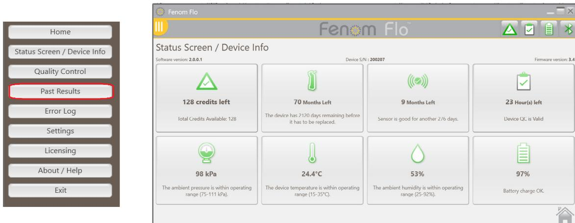
3. Die Software-Version des Geräts, der Gerätestatus und die Firmware-Version werden auf dem Bildschirm „Statusbildschirm / Geräteinformationen“ angezeigt. Das verfügbare Testguthaben, der Status der Qualitätskontrolle, der Status des Geräts und des NO-Sensors, der Batteriestatus und die Umgebungsbedingungen des Geräts (Druck, Temperatur und Luftfeuchtigkeit) werden ebenfalls auf diesem Bildschirm angezeigt.
